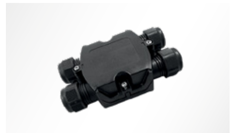
Connessione elettrica tramite connettore rapido presa-spina realizzato in PA66 senza alogeni e fosforo con contatti in rame argentato, per cavi Ø 9 - Ø 14 mm.
