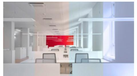
Le versioni HCL e Tunable-White riproducono l'andamento dinamico della luce naturale e variano il livello di intensità luminosa e il colore della luce da 2.700 K a 6.500 K a seconda dell'ora del giorno.
