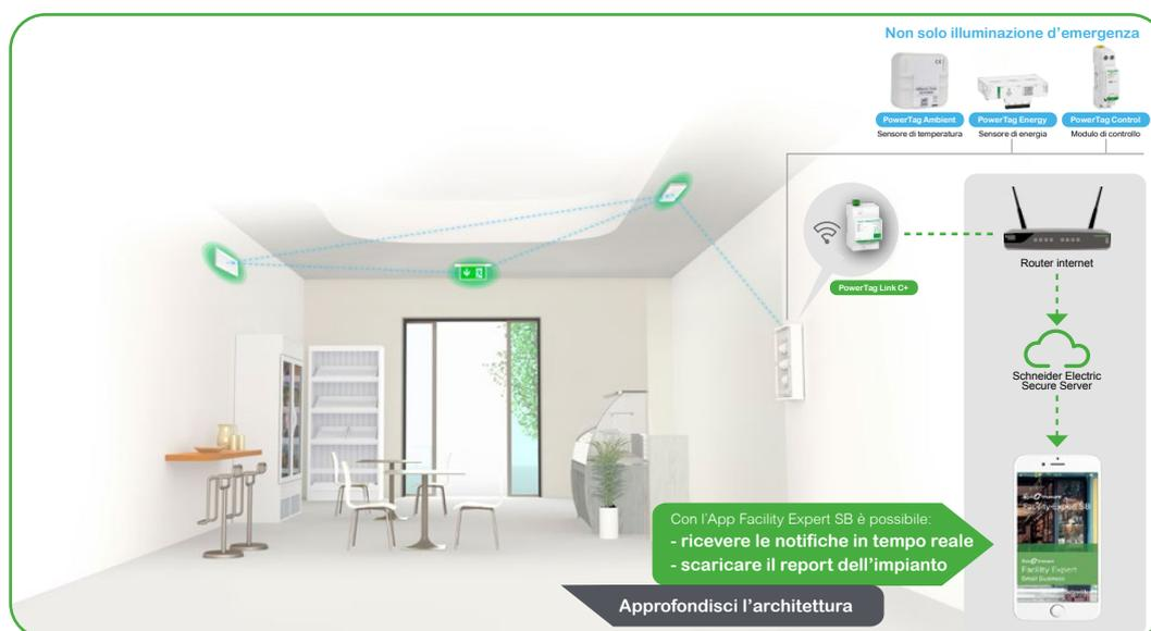
Il limite di apparecchi per 1 concentratore è di 20. Installare gli apparecchi ad un massimo di 10 metri tra loro.
