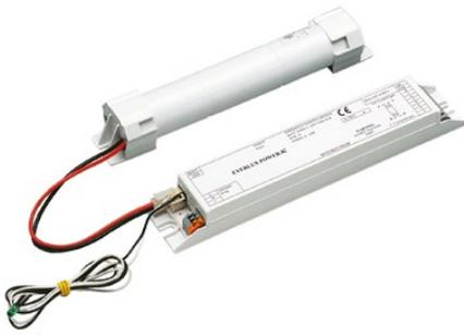
I kit di emergenza Evx sono dispositivi che, inseriti in plafoniere con tubo fluorescente, permettono di realizzare un sistema autonomo di luce di emergenza con intervento automatico.
