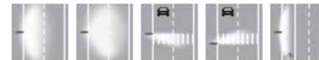
T2 STRADALE MEDIA ME STRADALE AMPIA SPD PEDONALE DESTRA SPS PEDONALE SINISTRA PC PISTA CICLABILE
